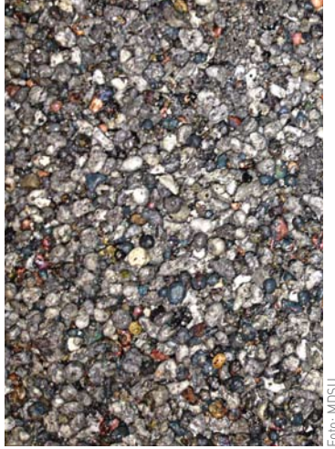
Bei der Aufbereitung entstehen Recyclingbaustoffe in verschiedenen Körnungen.
